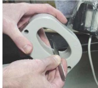
Fig. 47 Using demagnetizer
